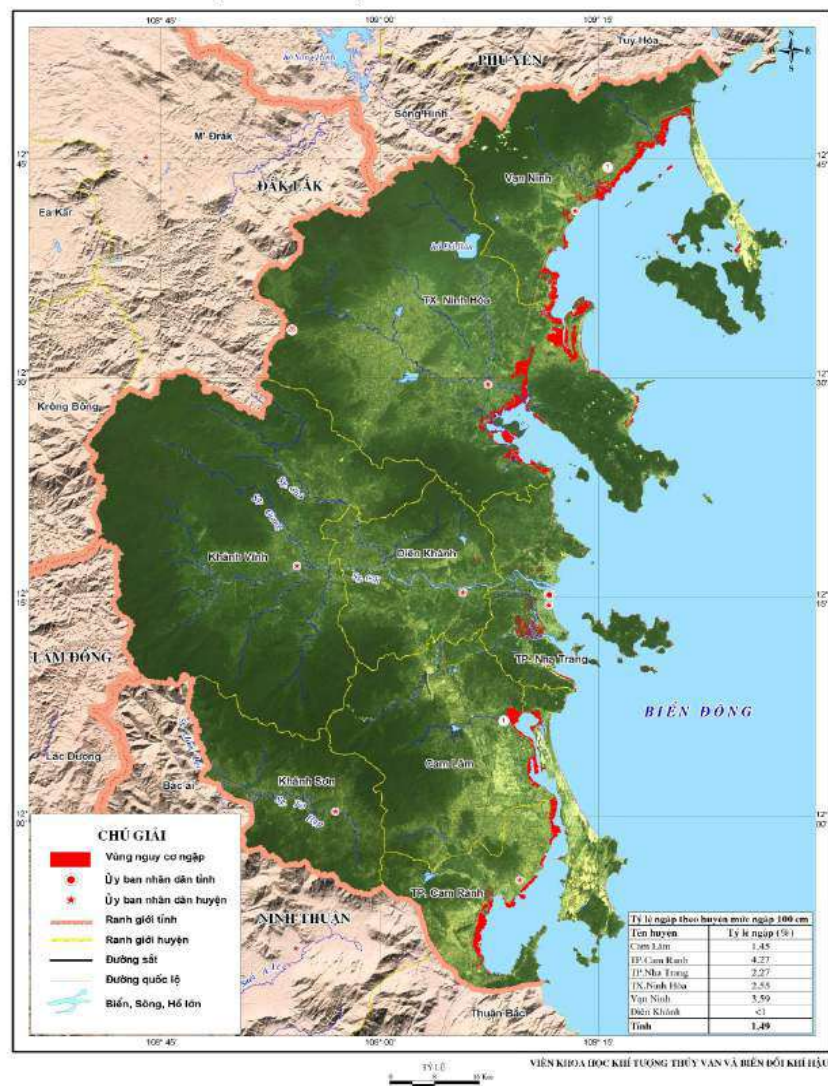
Hình 5.6: Sơ đồ nguy cơ ngập ứng với mực nước biển dâng 100 cm
